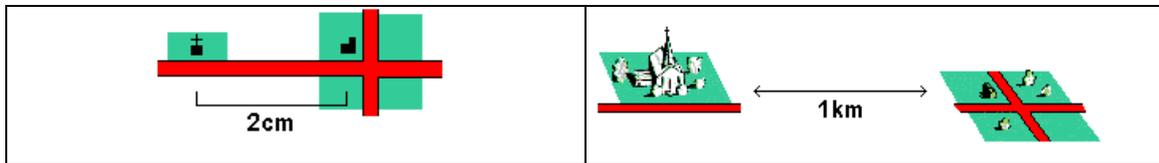
$$\frac{\text{Distancia sobre el mapa}}{\text{Distancia sobre el terreno}} = \frac{2 \text{ cm}}{1 \text{ km}} = \frac{2 \text{ cm}}{100.000 \text{ cm}} = \frac{1}{50.000}$$
