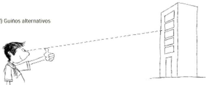
Con el brazo estirado, utilizar como mira el dedo pulgar para ubicar dos puntos sobre el edificio, mirando primero con un ojo y después con el otro. Estimar la distancia entre ambos puntos, multiplicarla por 10 para obtener una estimación de la distancia que los separa del edificio. El factor 10 deriva de la razón entre la medida aproximada de la distancia entre ambos ojos (6 cm) y la longitud de los brazos (60 cm) un promedio aproximado y cómodo para hacer los cálculos.
