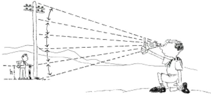
Colocar al pie de un poste una persona o vara de altura conocida. Ubicarse a una distancia adecuada, mirando con un solo ojo y recurriendo a un lápiz o varita que se sostiene con la mano, cubrir la persona y contar cuántas veces cabe en la altura de dicho poste.
